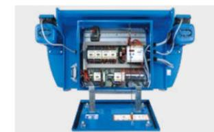
Il controllo mediante l'unità di controllo ABUS LIS, dalla manutenzione semplice, offre le funzioni salvamotore, contatore di funzionamento e limitazione del carico.
