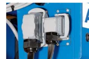
Con i connettori a spina rapidi preinstallati ABUS è possibile ridurre al minimo i lavori di montaggio e di manutenzione. Con pochi gesti è possibile collegare e scollegare i dispositivi elettrici. Un ulteriore vantaggio: non è possibile fare confusione con i collegamenti.
