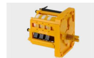
Il finecorsa di sollevamento ABUS garantisce il rispetto preciso della posizione di massimo sollevamento o di massimo abbassamento del gancio. Due punti di intervento di serie per la posizione di massimo sollevamento del gancio offrono una doppia sicurezza. In caso di necessità è espandibile come finecorsa di funzionamento [a richiesta].
