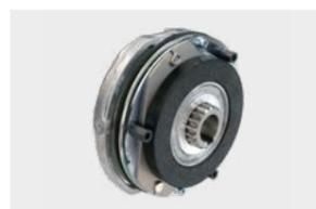
Il freno elettromagnetico a due dischi offre una frenatura automatica in caso di mancanza di tensione. Le guarnizioni del freno, prive di amianto e con durata di circa 1 milione di azionamenti, prolungano gli intervalli di manutenzione.
