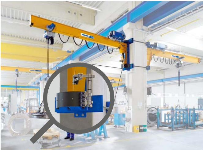
Interruttore di finecorsa per rotazione VW (figura 7)
