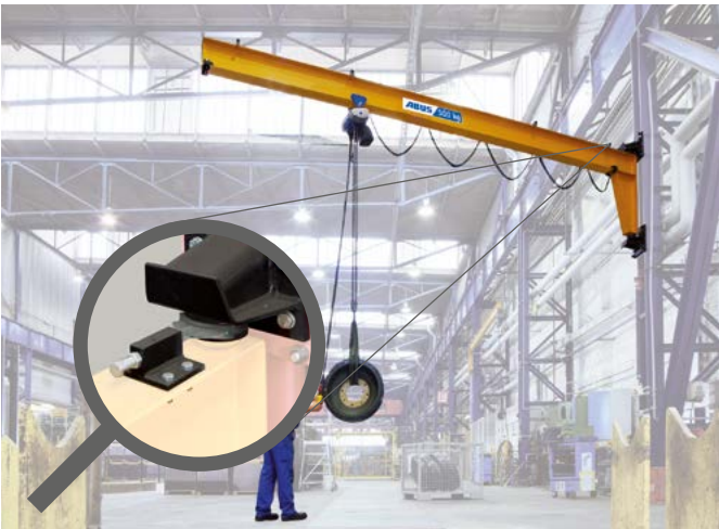
Regolazione della resistenza alla rotazione VW (figura 10)
