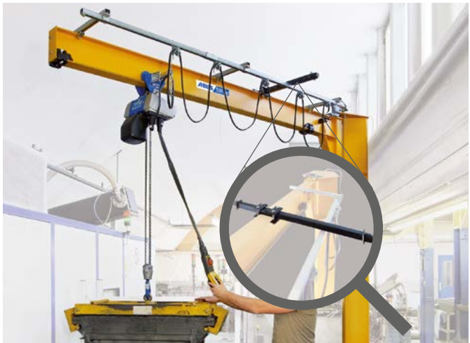
Barra di spinta per arresto della rotazione (figura 4)
